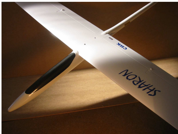
lange, geräumige Rumpfspitze mit optisch perfekter Carbon-Kabinenhaube
