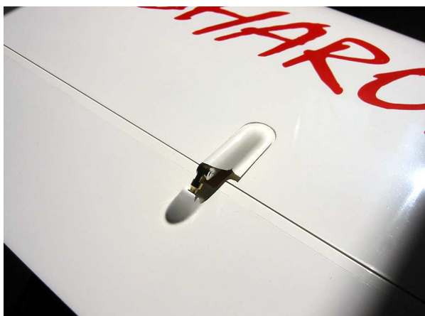
Flügeloberseite Wölbklappe mit Spaltabdeckung
