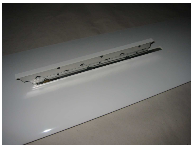
doppelstöckige Störklappe mit farblich passendem GFK-Abdeckstreifen
